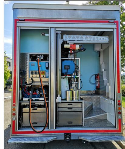
**SPECIALS:** Alimentation électrique hybride TRIPLE, système de générateur DC Whisper Power, Pack de batteries 8x batterie GEL 24V 900Ah, Système solaire 1710 watts sur le toit du coffre
